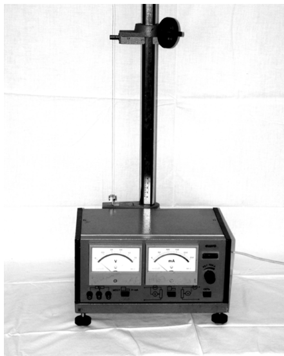
Рис. 9.1. Установка для измерения удельного сопротивления тонкого провода
